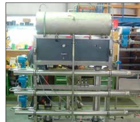
Een kleine installatie voor het terugwinnen van organische oplosmiddelen met een hoog kookpunt (links de unit in opbouw).
