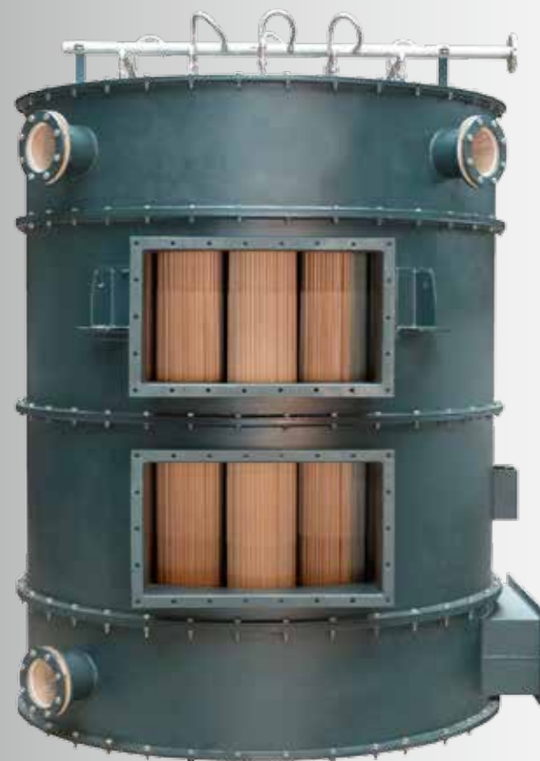
De warmtewisselaar is gemaakt van een hoogwaardige kunststof die continu temperaturen tot 200°C kan verdragen en bestand is tegen geconcentreerd zwavelzuur.
