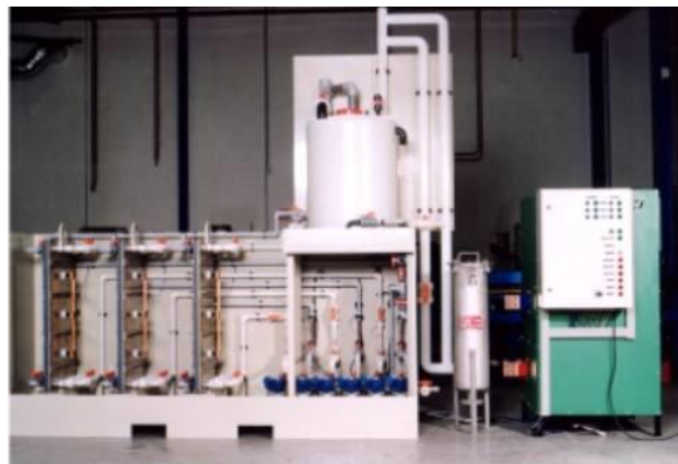
Membraan elektrolyse chroomzuurreiniging
